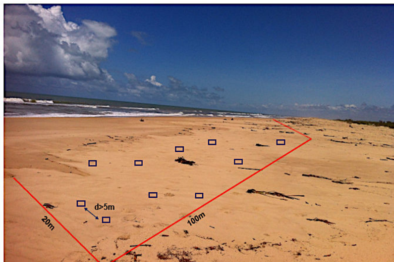
Figura 7.3. Imagem ilustrativa da metodologia de coleta de sedimentos na área de estudo em uma área de 2000 m 2 (100 m x 20 m). Onde d é a distância mínima entre os quadrantes de coleta (50 cm x 50 cm).
