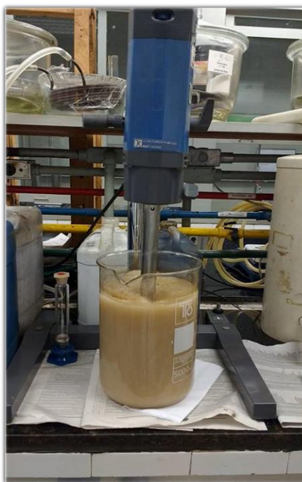
Figura 4.8.: Preparo de 4L de água oleosa sintética com agitador Turrax T-50.
