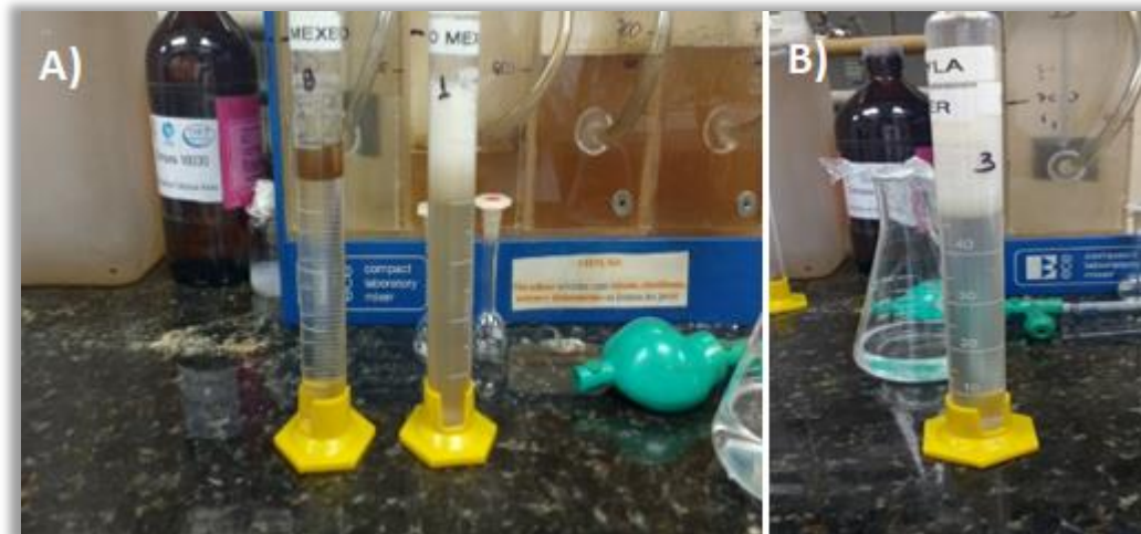
Figura 5.24: observação da fase aquosa A) após uma extração e B) após três extrações
