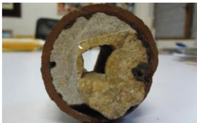
■ Ejemplo de incrustación sílice y minerales.
