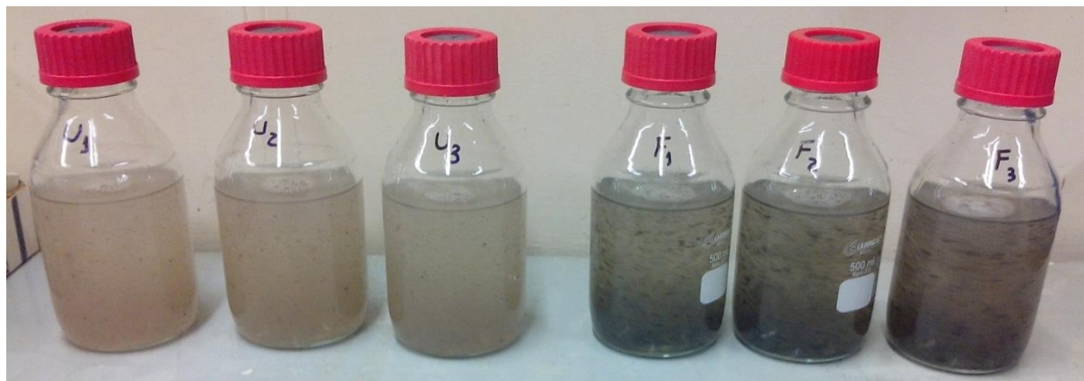
Figura 21 – Reatores preparados para o ensaio cinético desnitrificante com lodo suspenso
