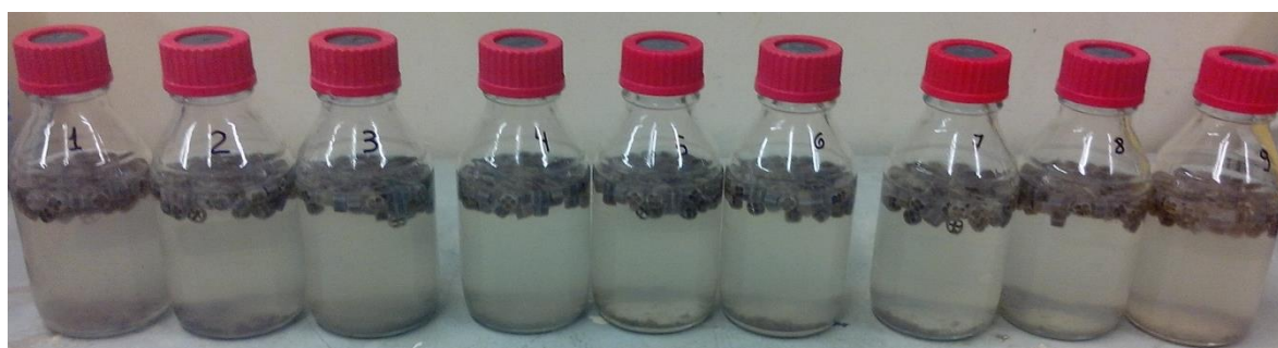
Figura 24 - Reatores após o ensaio cinético desnitrificante com meio suporte.
