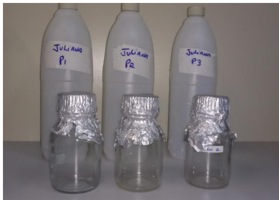
Figura 17 - Frascos utilizados para a coleta da água de chuva
