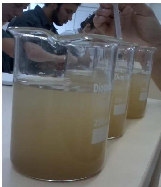
Figura 02 – Adição de sulfato de alumínio [Al_2(SO_4)_3] . Fonte: Autor.
